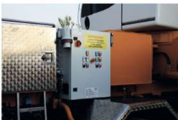
Elettropompa ausiliaria per utilizzo ecologico 380 Volt 22 kW con inverter Auxiliary electric pump (380 Volt / 22 kW with inverter)
